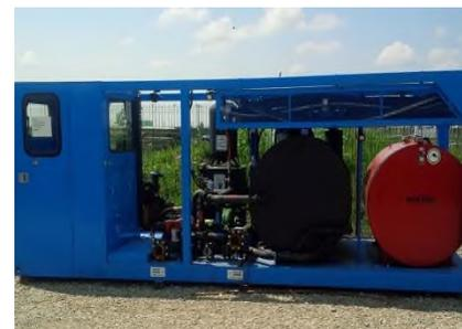
**Нагревательно – фильтрационная установка**
